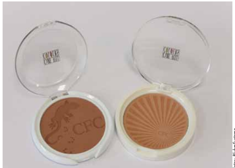
Die Pudersteine lassen sich mit dem Laser einfach, kostengünstig und absolut präzise mit Logo oder Markennamen versehen.
