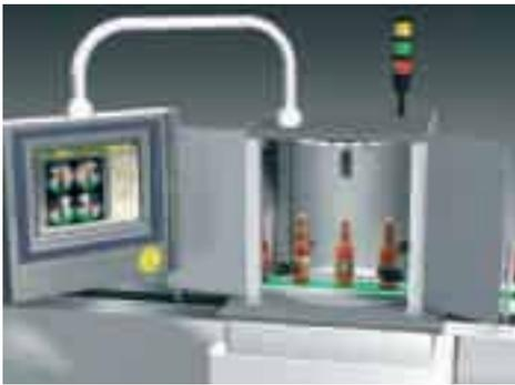
installierten Kameras, mit denen das Produkt von allen Seiten simultan erfasst wird. Diese jeweiligen Bilder werden mit Hilfe spezieller Bildverarbeitung in einem 3D-Modell abgebildet und dann unter Verwendung der Cognex VisionPro® Software-Bibliothek geprüft. Eine zusätzliche fünfte Kamera kann beispielsweise dazu verwendet werden, die fehlerfreie Übereinstimmung von Deckel oder Verschluss mit dem Etikett der Verpackung zu kontrollieren.
