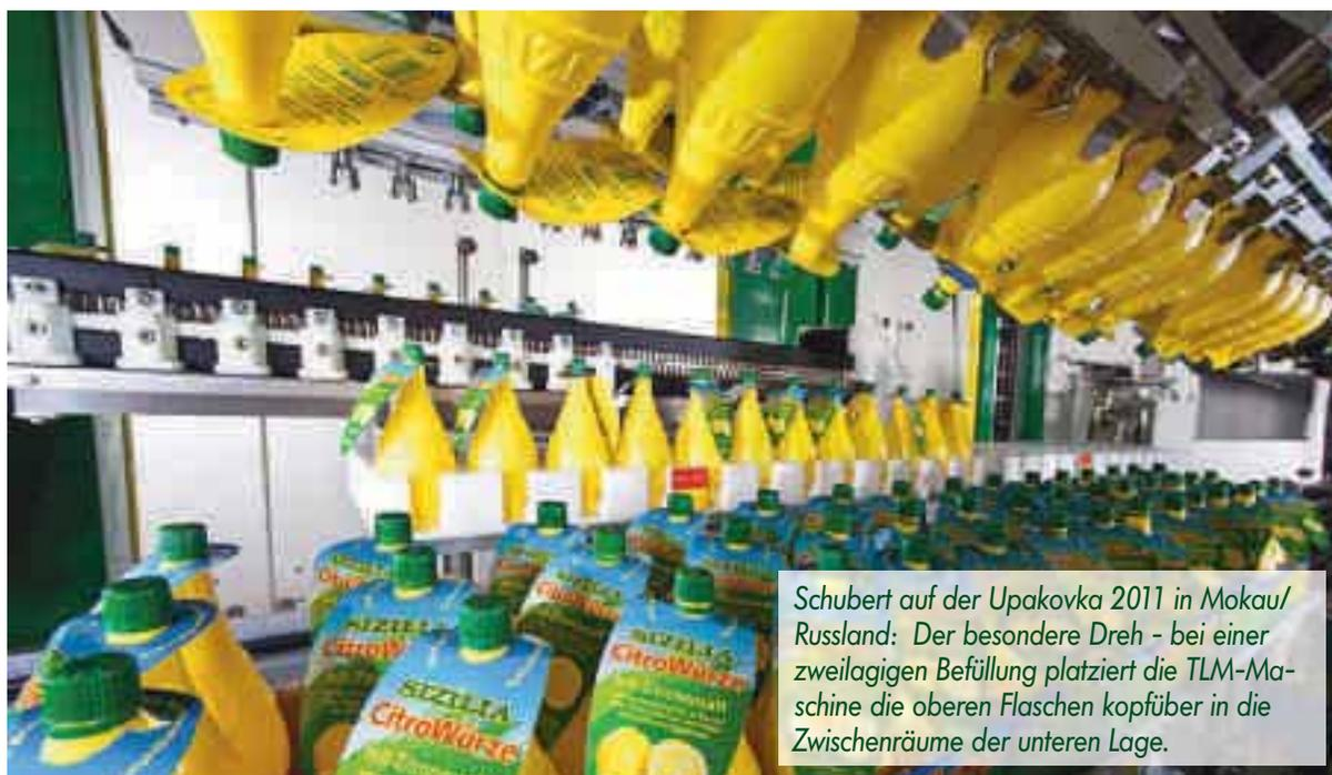
*Schubert auf der Upakovka 2011 in Moku/Russland: Der besondere Dreh - bei einer zweilagigen Befüllung platziert die TLM-Maschine die oberen Flaschen kopfüber in die Zwischenräume der unteren Lage.*
