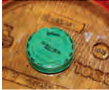
nicht realisieren lassen, da die zu bedruckende Fläche begrenzt ist. Hier haben wir mit der DoD-Inkjet-Drucklösung von Atlantic Zeiser einen echten Quantensprung machen können. Durch den Einsatz UV-härtender Tinten haben wir eine kompakte Drucker-Trockner-Kombination verwirklicht, die neben einer optimalen Haftung ein gestochen scharfes Druckbild auf den KEG-Fass-Abdeckungen gewährleistet - und die Tinten trocknen nicht mehr wie früher ein!“
