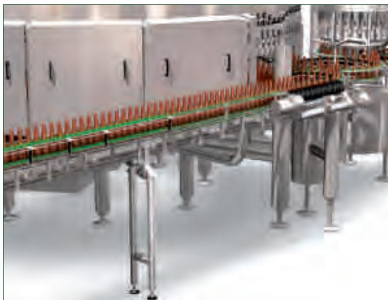
*Der neu konzipierte Transporteur zur Einlaufschnecke trägt ein automatisches Reinigungssystem in sich, bei dem die Spritzdüsen auf kritische Stellen ausgerichtet sind.*
