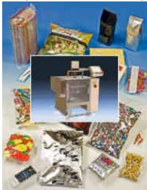
Computerunterstützte Technologien bei der Herstellung von TOSS Formschultern- und Formatsätzen gestatten, daß alle maschinengängigen Monofolien, wie z.B. aus den Werkstoffen PE und PP, aber auch spezielle Folienarten (Lamine oder auf das Produkt angepasste Verpackungsmaterialien), optimal auf den Maschinen verarbeitet werden können. Es kann mit Impulsschweißung und/oder Heißsiegung gearbeitet werden.
