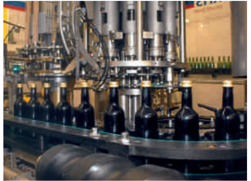
Dem Füllsystem direkt nachgeschaltet sind sowohl Kork-, als auch Kronkork- und Schraubverschluss, die wahlweise zum Einsatz gelangen.
