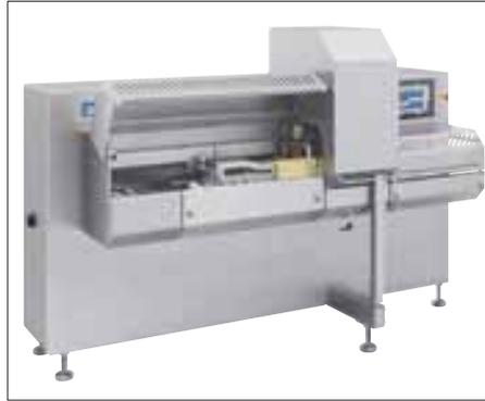
tionslinie erweitern. Mit integrierter Riegelwaage und Konturerfassung schneidet der CUT Basic fixgewichtige Käseportionen.
