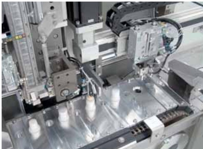
werden. Das gezeigte Einstiegsmodell OPTIMA CFL1 produziert ab 50 Verschlüsse/min. In der Top-Version können bis zu 1.000 Functional Closures/min befüllt, versiegelt und kontrolliert werden. Weitere Neuerungen wie der CombiStick als der neue, bessere „Teebeutel“, die Flüssigaromadosierung für Kaffeepartionspackungen oder die Weichdose SoftCan werden auf dem Messestand von den Experten vorgestellt.
