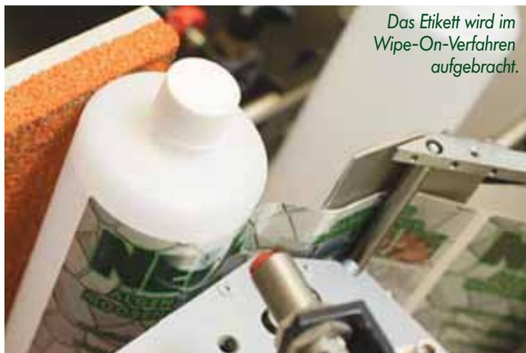
Das Etikett wird im Wipe-On-Verfahren aufgebracht.
