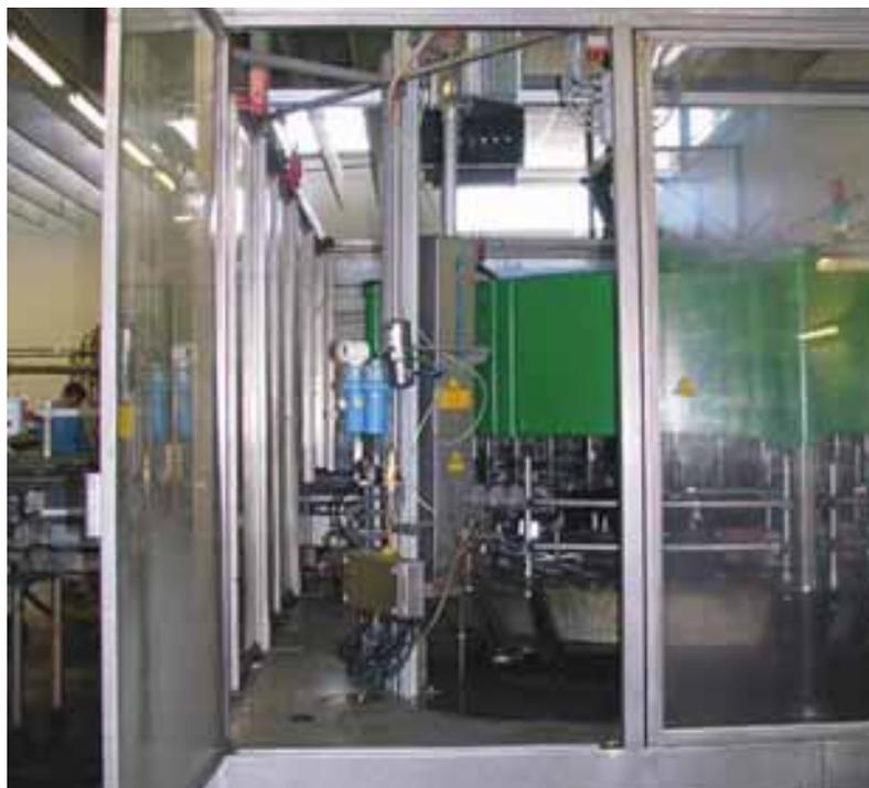
Modernste Technik im gesamten Herstellungsprozess – der Kennzeichnungslaser wurde platzsparend mit einer Halterung oberhalb des Etikettierers installiert.
