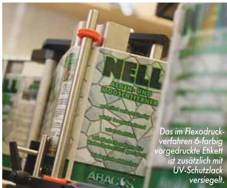
Das im Flexodruckverfahren 6-farbig vorgedruckte Etikett ist zusätzlich mit UV-Schutzlack versiegelt.
