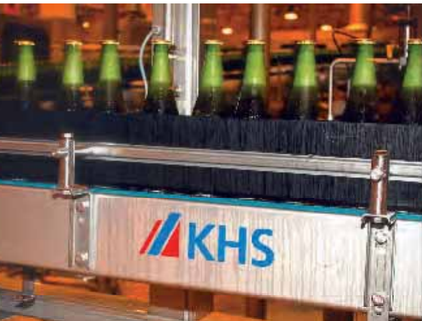
Glasflaschen durchlaufen im Anschluss an den Füllprozess den Pasteur und werden schließlich der Etikettiermaschine Innoket SE zugeführt.
