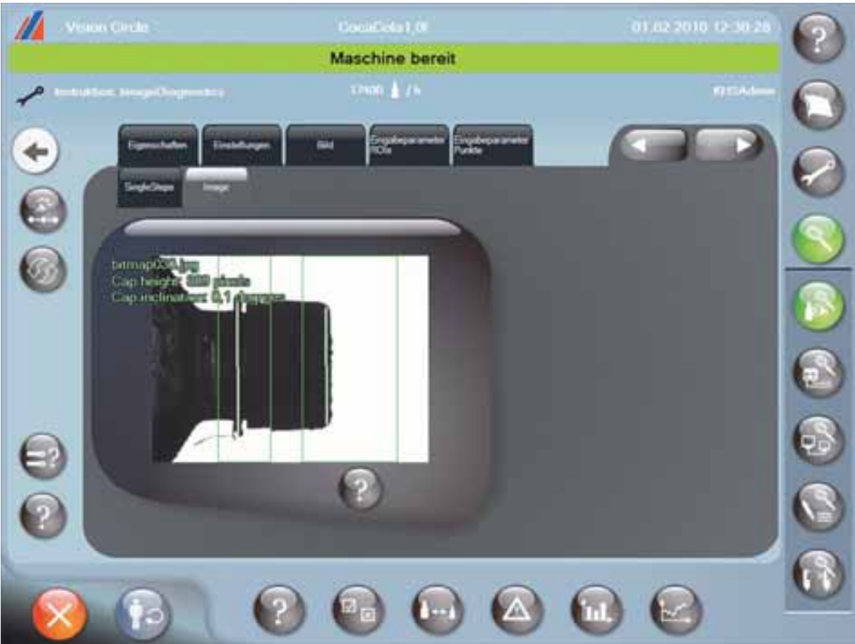
In die neue Innocheck-Plattform sind bei Coca-Cola Hellenic Österreich derzeit das Steuergerät Innocheck CUB mit Touch Screen Monitor zur Bedienung und Visualisierung sowie die Füllhöhenkontrolle Innocheck FHC und die Deckelschiefsitzkontrolle Innocheck CCI integriert.
