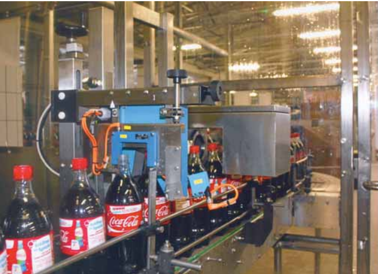
Vor jeder Inspektion triggern Lichtschranken PET-Flaschen auf Anwesenheit
