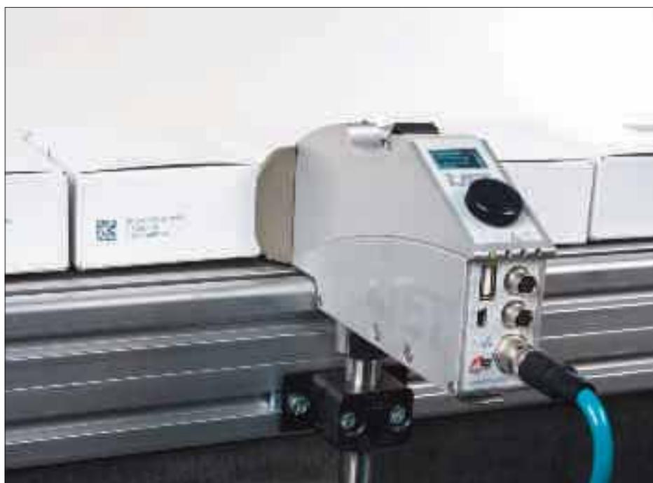
Der thermische Inkjet-Codierer iJET lässt sich problemlos in Verpackungsanlagen wie auch in komplexe Track & Trace-Anlagen integrieren.
