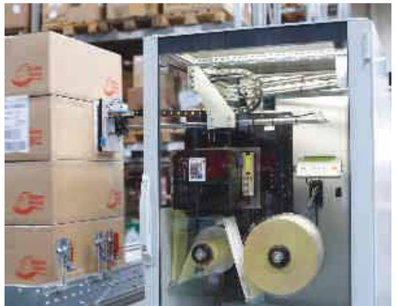
Der Legi-Air 4050 P etikettiert bis zu 420 Paletten pro Stunde im Durchlauf.
