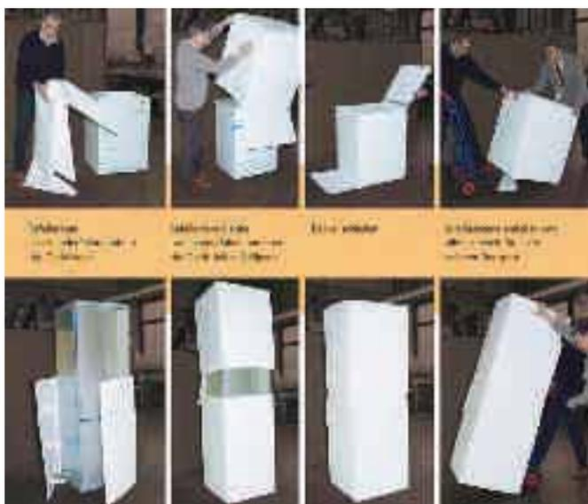
geeignetes Verpackungsmaterial „an Bord“. Die einmal ausgepackten Geräte werden auf den Logistikwegen oft ohne Schutz transportiert. Das schlägt sich im wahrsten Sinne des Wortes auf die Gehäuse der Maschinen nieder. Reklamationen, Ärger und Kosten sind die Folgen.
