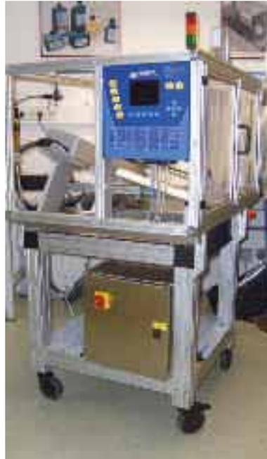
industriellen Thermo-Inkjet Drucker dienen zum berührungslosen Druck. Durch ein Kartuschenkonzept, kommen sie komplett ohne Solvent aus (somit haben Sie auch keine Probleme mit Gefahrgut!). Da sich die Tinte auf die Kartusche im Druckkopf beschränkt, benötigen diese Geräte keine regelmäßige Wartung
