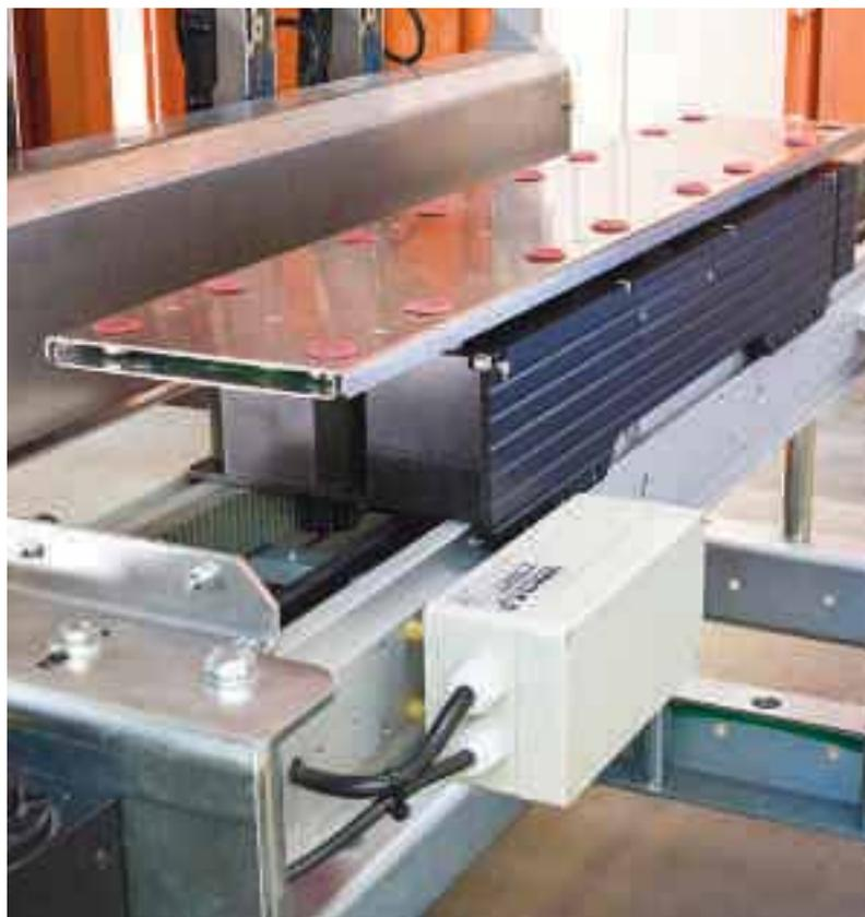
Ausgestattet mit dem neuen Signallampen-System, den neuen TLM-F3 Robotern zur Übergabe des Packmaterials und dem neuen Transmodul-Schienensystem, auf dem sich die ersten Transportroboter der Welt bewegen, wurden Schokoladen-Osterhasen verpackt. Auf der Schubert TLM-Verpackungsmaschine lassen sich natürlich ebenso Schokoriegel, Bonbonbeutel, Pralinen oder Marmeladegläser verpacken, weil die hohe Flexibilität des Maschinensystems dies zulässt.
