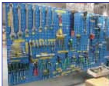
Bild oben: Alle Werkzeuge kamen aus der Werkzeugkiste und wurden beschriftet und mit Schatten und Foto hinterlegt
