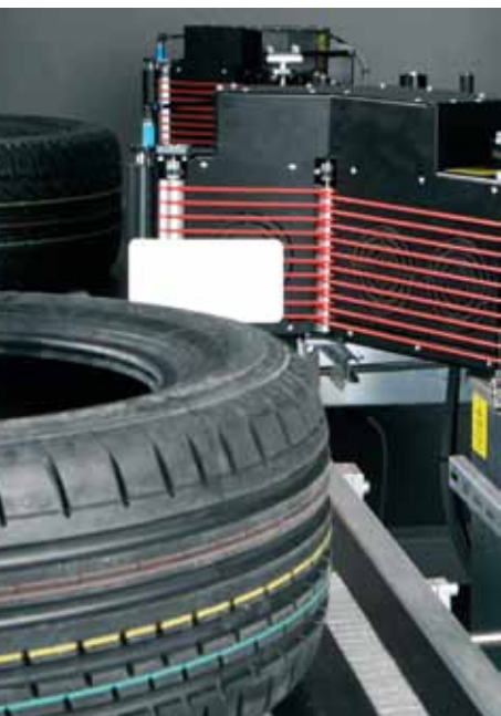
Reifenetikettierer Applikator: Der Applikator ist so konstruiert, dass er in jedem Fall das Produkt erreicht.
