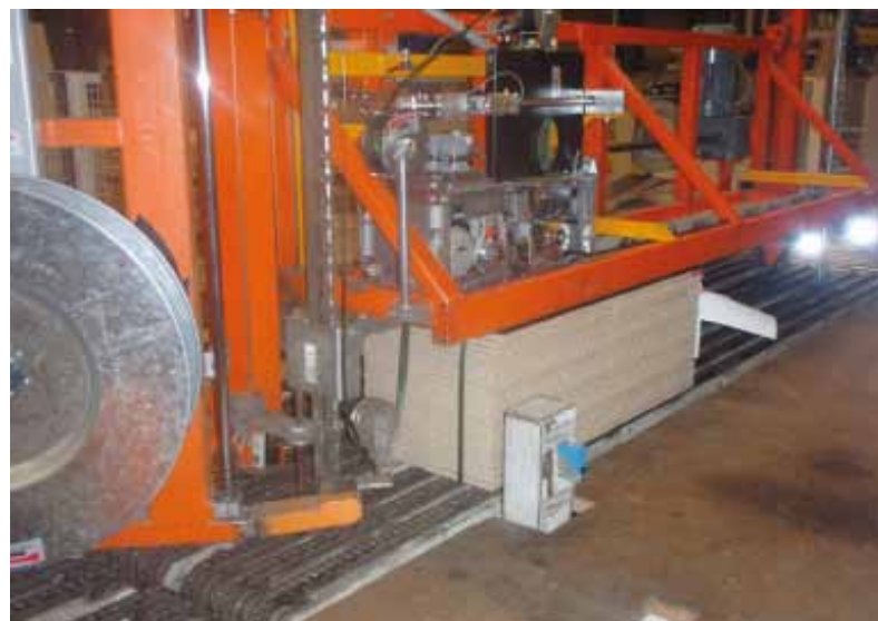
Umgerüstete Maschine – hier konnten fast alle bestehenden Teile verwendet werden (gelb=neu)
