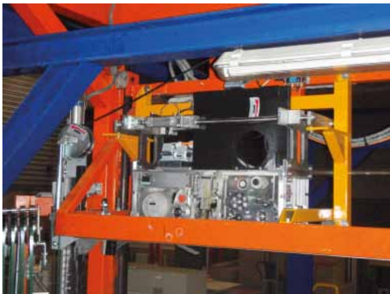
Umgerüstete Maschine – neuer Kopf mit Halterung (gelb)
