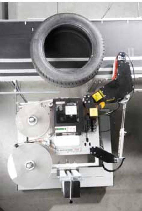
Reifenetikettierer Applikator: Der Applikator ist so konstruiert, dass er in jedem Fall das Produkt erreicht.
