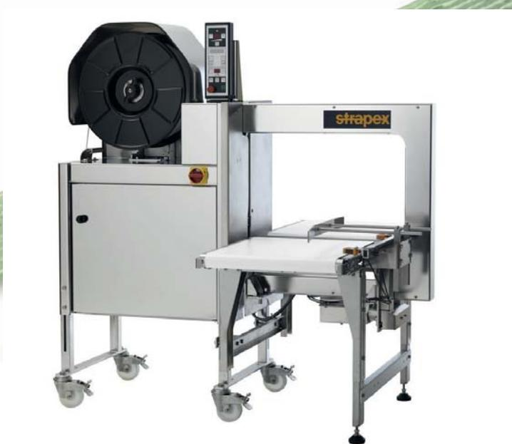
Die rostfreie Seitenkopfmachine ist die perfekte Lösung zum Umreifen in der Lebensmittel- und Chemieindustrie. Mit dem integrierten Fördersystem fügt sie sich einwandfrei in den Arbeitsprozess ein.
