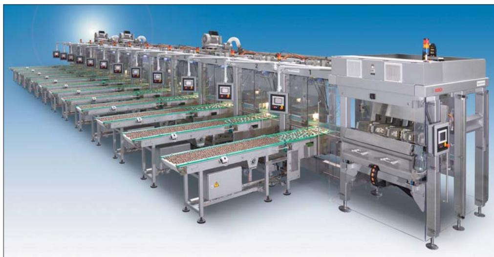
Die neue Delta-Roboter-Plattform LDx von Sigpack Systems, ein Unternehmen der Bosch Packaging Technology, eignet sich für Anwendungen in der Pharma-, Lebensmittel- oder Süßwarenindustrie. Die gesamte Plattform besteht aus kompakten Zellen mit integrierten Delta-Robotern, die sich einfach und flexibel unterschiedlichen Anforderungen anpassen lässt.
