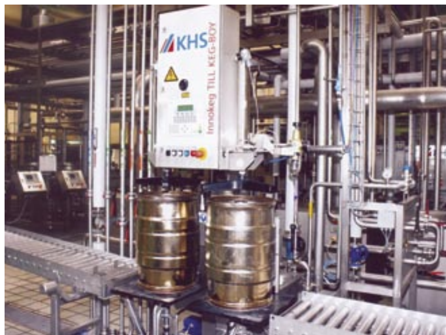
Eine weitere Investition fand bei der Lasko Brauerei in die halbautomatische Keg-Reinigungs- und Füllmaschine Innokeg Till Keg-Boy C2 statt.
