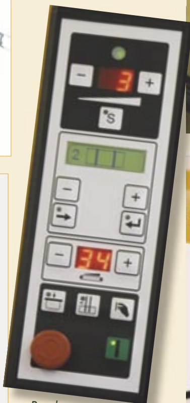
Bandspannung einstellbar über Drucktaste
