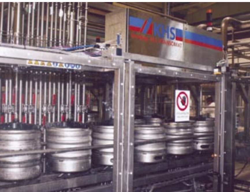
Zwei Innokeg Till TRANSOMAT 5/1 Duo realisieren bei der Brauerei Lasko eine Leistung von 320 Kegs/h.
