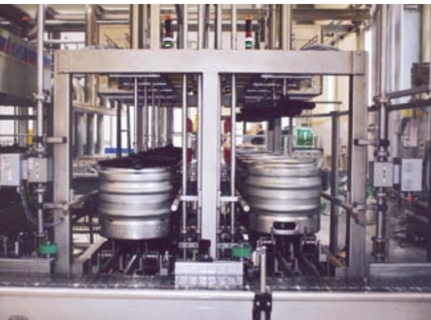
Jede der Innokeg Till TRANSOMAT 5/1 Duo-Linien verfügt über zwei Behandlungsstränge. Ein Behandlungsstrang beinhaltet eine Füll- sowie fünf aktive Reinigungs- und Sterilisationsstationen.
