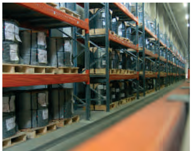
Sonderlösung: Hier können die Sonderpaletten mit einem Überstand von 100mm oder mittig über den Palettenquerträgern gelagert werden.
