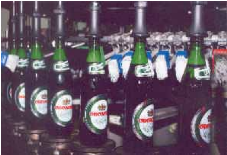
Die präzise Flaschenausstattung übernimmt die bewährte Etikettiermaschine Innoket KL 2080.
