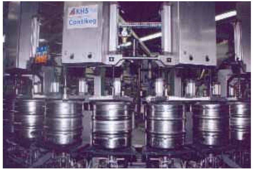
Aufgestockt: Statt bislang 400 Kegs/h verarbeitet die Innokeg Contikeg-Linie nun 1.000 Kegs/h.
