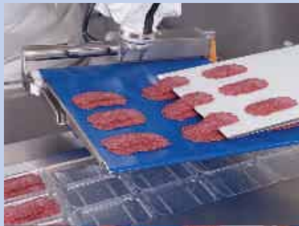
Weber WFR 2-lagig.jpg WFR sausage. Vielfältig und hygienisch: mehrlagig in die Verpackung einlegen mit dem Weber Food Robot.
