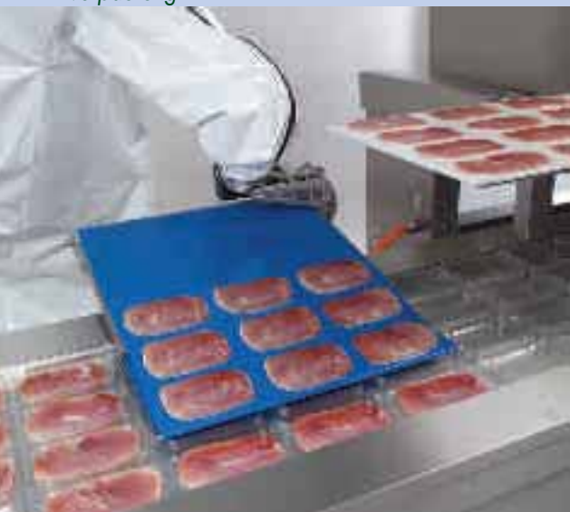
Weber WFR 2-lagig.jpg WFR sausage. Vielfältig und hygienisch: mehrlagig in die Verpackung einlegen mit dem Weber Food Robot.
