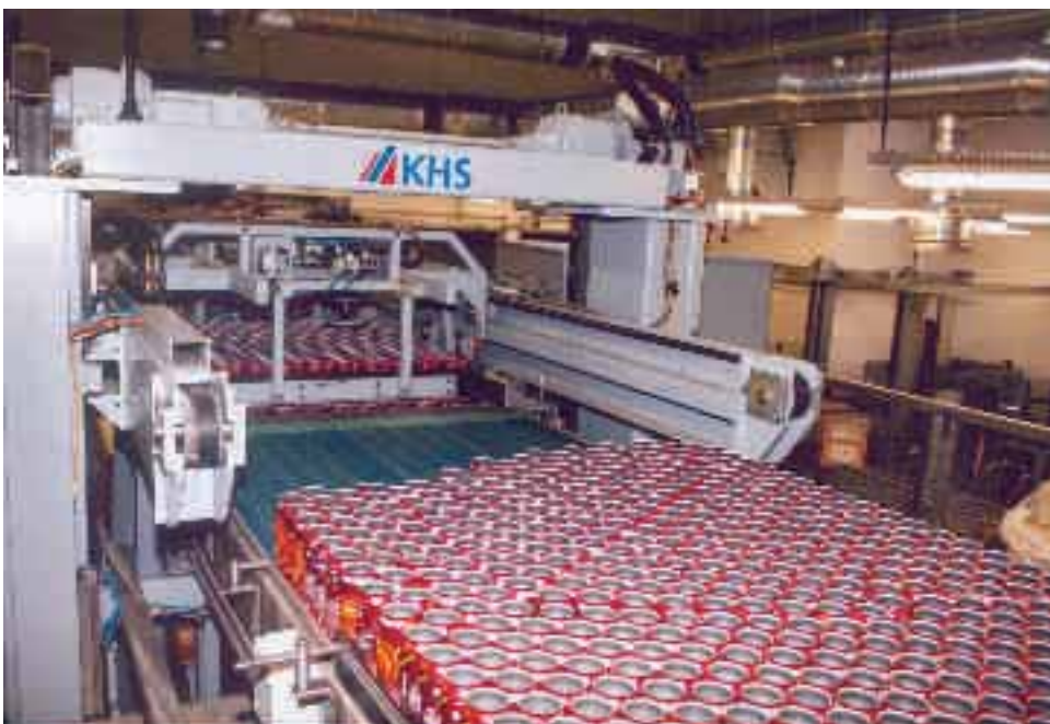
Neben Bier verarbeitet die neue KHS-Dosenlinie Bier-Mixgetränke, alkoholfreies Bier und Erfrischungsgetränke. Im Bild der Abräumer Innopal ASH.
