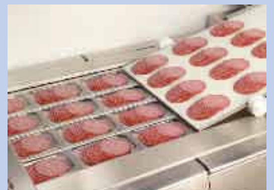
Der Weber Compact-Loader transportiert die Portionen vollautomatisch auf kleinstem Raum zur Verpackungsmaschine.
