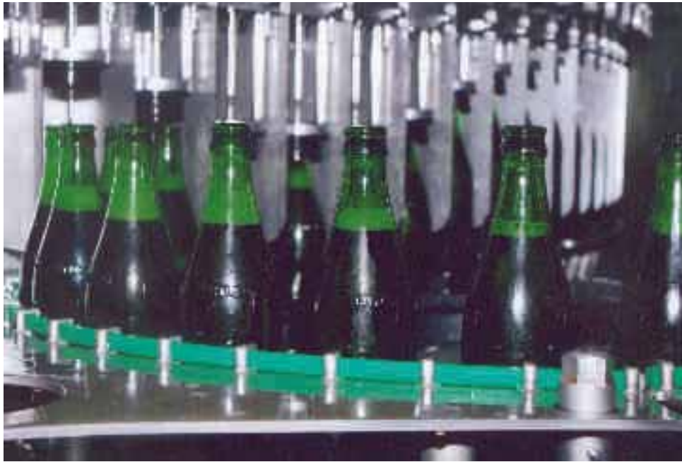
Steht für die sauerstoffarme Abfüllung von Bier in Glasflaschen: der Füller Innofill DRS-ZMS.
