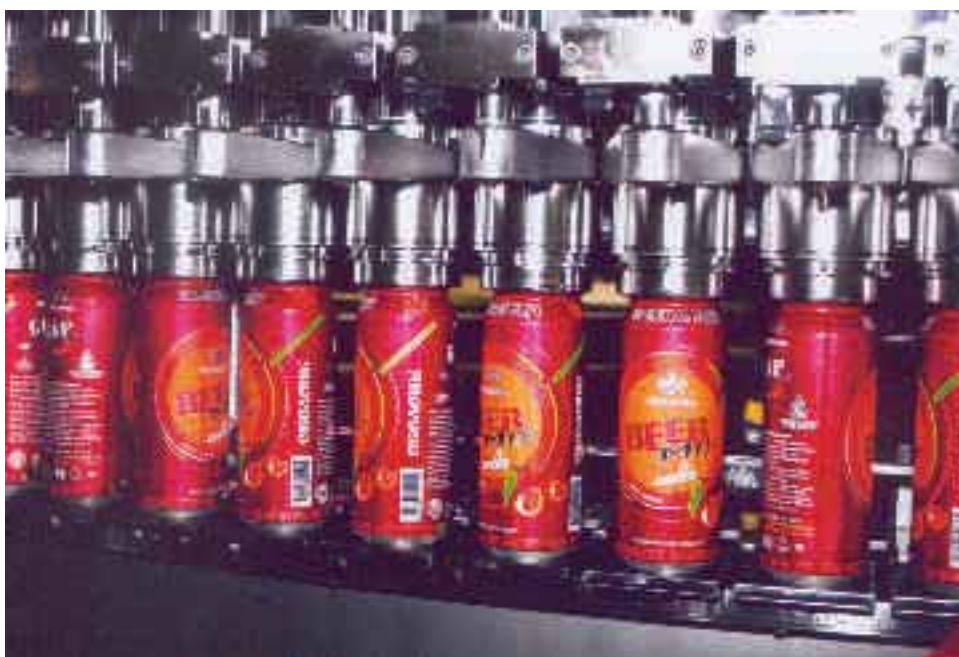
...geht es direkt zum Herzstück der Linie, dem Dosenfüller Innofill DMD. Er verfügt über eine robuste Konstruktion und ist bei höchster Leistung und bester Abfüllqualität äußerst langlebig
