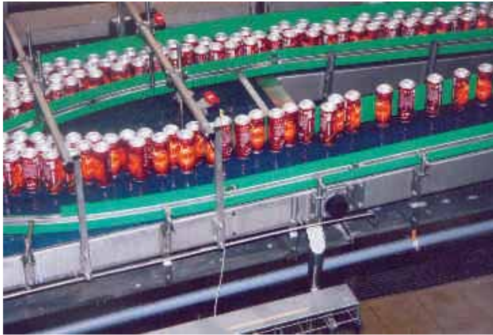
Um den Fluss der Linie aufrecht zu erhalten, integrierte KHS die dafür nötigen Pufferstrecken in die Dosenanlage.
